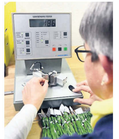
Wie weich und natürlich fühlt sich die Kunstrasenfaser an? Das überprüft Stefanie Malcherek stichprobenartig im Laborbereich der Qualitätskontrolle.
