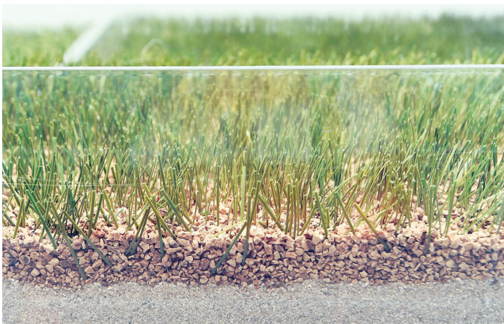
Der Nachhaltigkeitsgedanke rückt immer mehr in den Vordergrund, deswegen experimentiert die Firma Morton Extrusionstechnik in Ober-Abtsteinach, wie ein Kunstrasen umweltfreundlich hergestellt werden kann. Mittlerweile gibt es statt Einstreugranulat aus geschredderten Altreifen auch Alternativen aus Olivenkernschrot oder Kork (unser Bild). BILDER: MARCUS SCHWETASCH
